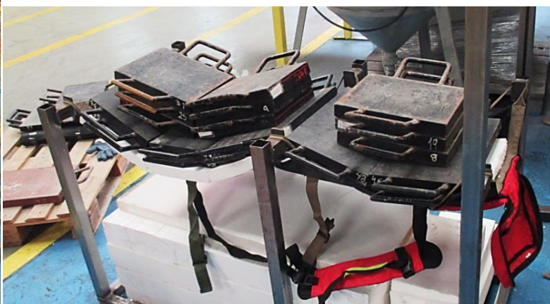
Camilla posición sentado y posición tumbado, CON CARGA DE 435 kg
