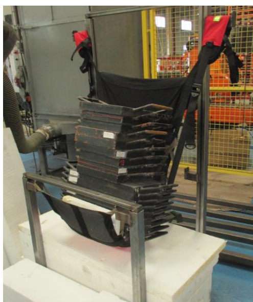
Camilla posición sentado y posición tumbado, CON CARGA DE 435 kg
