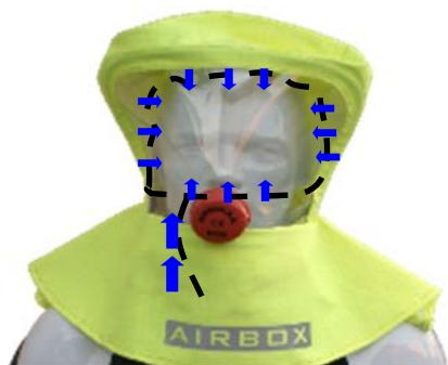
La salida del aire a través del capuz se realiza a través de chorros de aire multi-difuminado, colocados en todo el perímetro. Este innovador diseño impide la condensación del aire en el interior del capuz y la consecuente pérdida de visión. El aire sale de manera constante a través de múltiples orificios que dan un caudal constante de 40 l/minuto.
